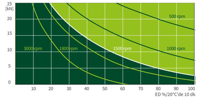
Bu haritalar, standart endüstriyel koşullar altında (ortam sıcaklığı 20°C vb.) yönlendirme ve doğru bakım (yağlama vb.) için kullanılır. Karakteristik diyagramlar ZIMM standart trapez diş Tr 30x6'e dayanmaktadır. KGT vidalı mil dişleri ile görev döngüleri çok daha uzun olabilir.
