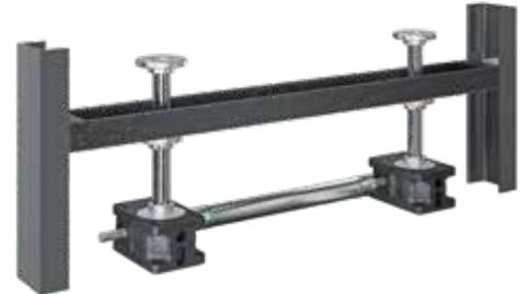
Auf Parallelität und Winkeligkeit der Anschraubflächen, Getriebe, Muttern und Führungen zueinander ist zu achten. Ebenso auf genaue Fluchtung der Getriebe, Stehlager, Verbindungswellen und Motor zueinander. Wir empfehlen das Ausrichten mit Hilfe einer Präzisions-Maschinen-Wasserwaage vorzunehmen.
